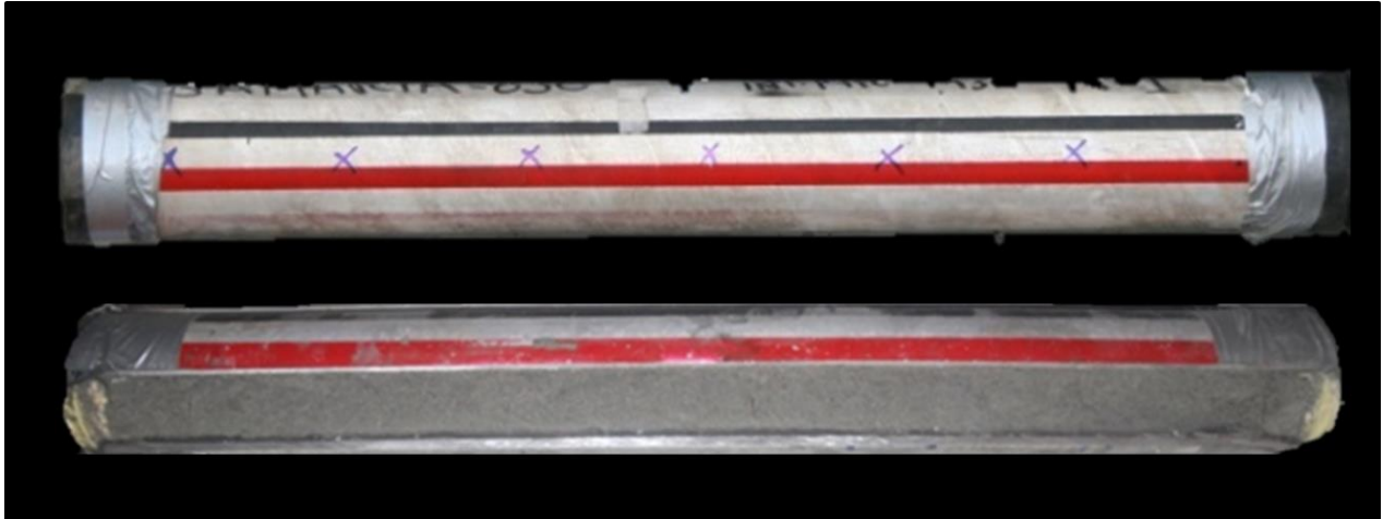
Fig. 8 Funda de aluminio alojando núcleo convencional “no consolidado”, se observan las líneas de orientación.
