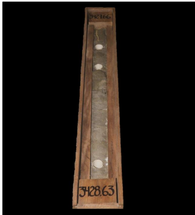
Fig. 11 Las cajas de madera deberán tener fondo cóncavo y una contratapa para estabilizar y fijar el núcleo.
