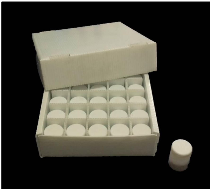
Caja de polipropileno celular con rejilla o panal para resguardar los frascos que resguardan los recortes de perforación.
