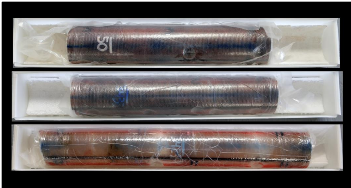
Fig. 3 Núcleo convencional de "Sal" preservado en bolsas al vacío y resguardado en cajas de polipropileno celular
