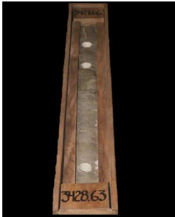
Las cajas de madera deberán tener fondo cóncavo y una contratapa para estabilizar y fijar el núcleo.
