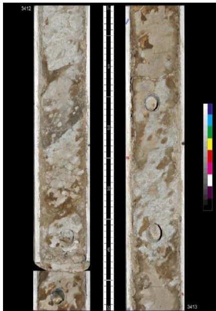
Fotografía digital de núcleo convencional "no consolidado" bajo luz blanca y luz ultravioleta, a través de la ventana cortada de la funda de aluminio.
